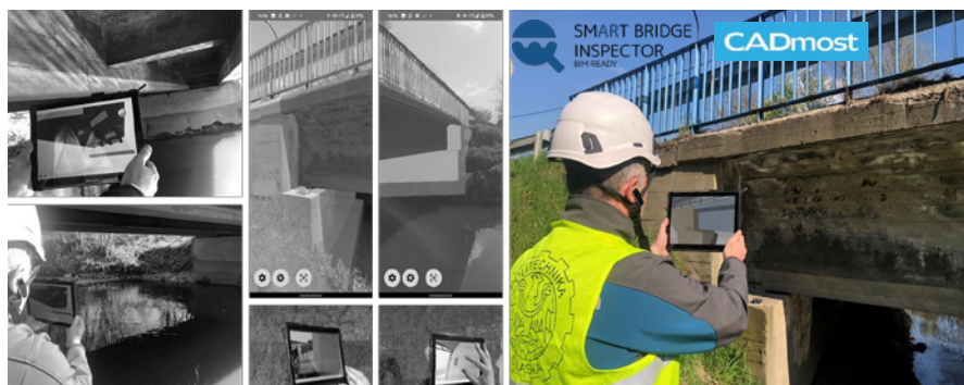
Ryc. 12. Wykorzystanie kamery wbudowanej w tablet i modułu poszerzonej rzeczywistości
